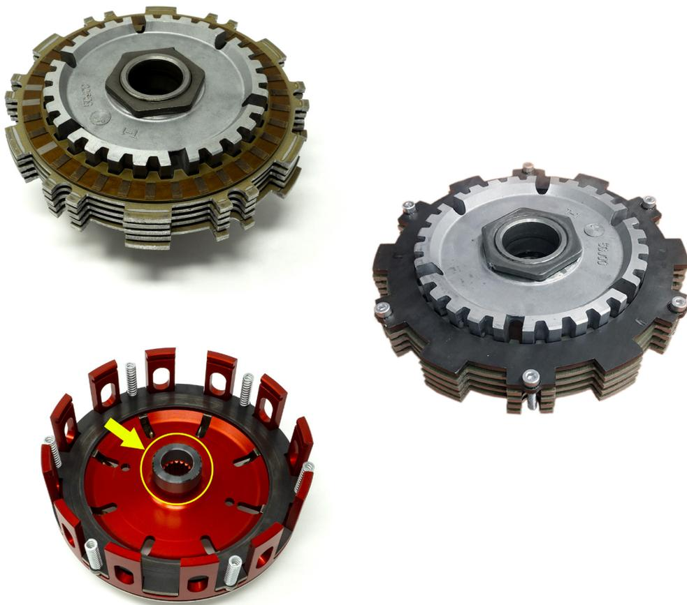
Prima di accoppiare la campana esterna, ricordarsi di mettere il distanziale che era all'interno della frizione originale (parte non fornita da Jetprime) nella stessa posizione, tra il suo lato interno e il bullone di fissaggio del mozzo.
