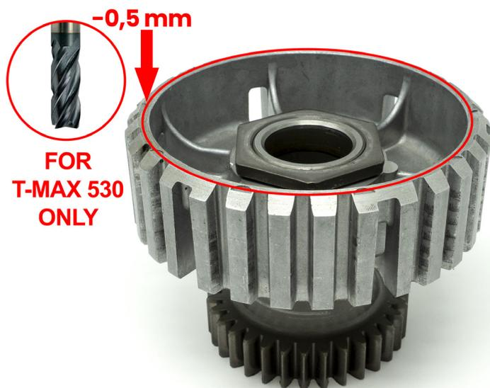
Ruotare il mozzo di 180° e riagganciarlo all'ingranaggio, quindi serrare il dado con una coppia di 90 Nm.
