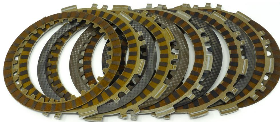
**Nota:** la misura a calibro del pacco dischi correttamente accoppiato è di circa 24,5 mm.
