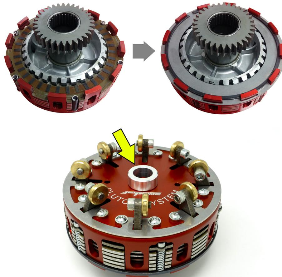
Rimontare il gruppo frizione completo sul motore, posizionando il nostro distanziale in alluminio sul perno della frizione, all'esterno della campana, prima di serrare il dado di fissaggio con 65 Nm (seguendo il manuale Yamaha) e bloccare il nuovo gruppo frizione.
